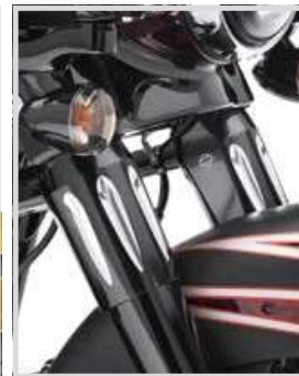
H. EDGE CUT TAUCHROHRABDECKUNGEN OBEN
