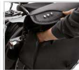
SCHRITT 2 Ziehen und drehen Sie die verborgenen Haltenocken, um die Taschen von der Befestigung zu lösen.
