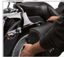
SCHRITT 3 Schieben Sie die Tasche nach hinten, um die Montagehalterung zu lösen und die Taschen herausnehmen zu können.
