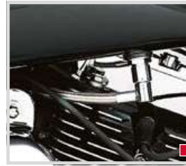
G. EDELSTAHLUMMANTELTE EFI KRAFTSTOFFLEITUNG
