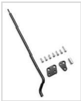
C. REACH UMBBAUKIT FÜR VORVERLEGTE FUSSRASTENANLAGE
