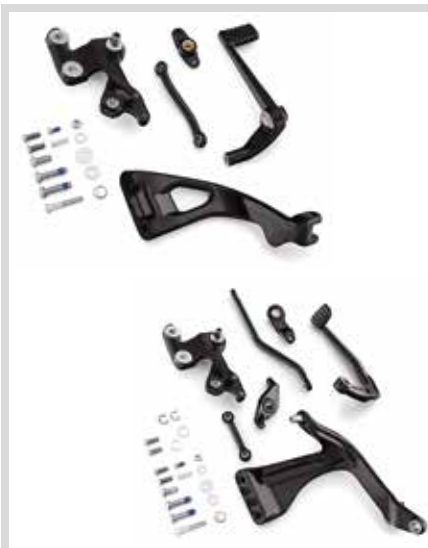
A. MITTIGE FUßRASTENANLAGE DER SERIENAUSSTATTUNG – BREMS- UND SCHALTSEITE
