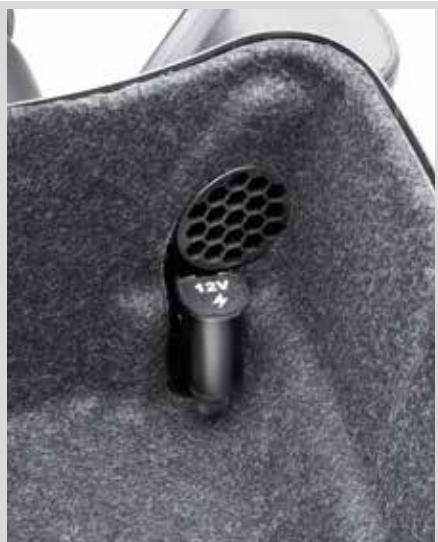
D. ZUSATZ-STROMANSCHLUSS – TOUR-PAK MONTAGE
