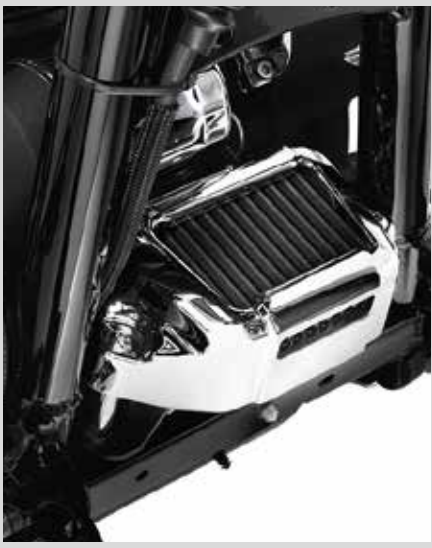
E. SPANNUNGSREGLERABDECKUNG – CHROM (MODELLE '09-'13 ABGEBILDET)
