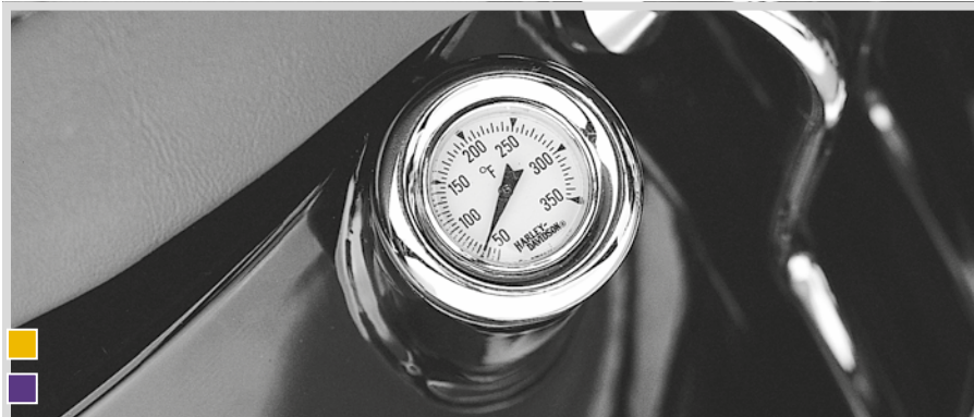
B. ÖLPEILSTAB MIT TEMPERATURANZEIGE (SOFTAIL ABGEBILDET)
