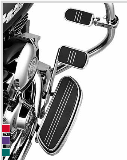
D. STREAMLINER FAHRERTRITTBRETTER-KIT (ABGEBILDET MIT BREMSPEDALAUFBLAGE UND FUSSRASTEN-KIT)
