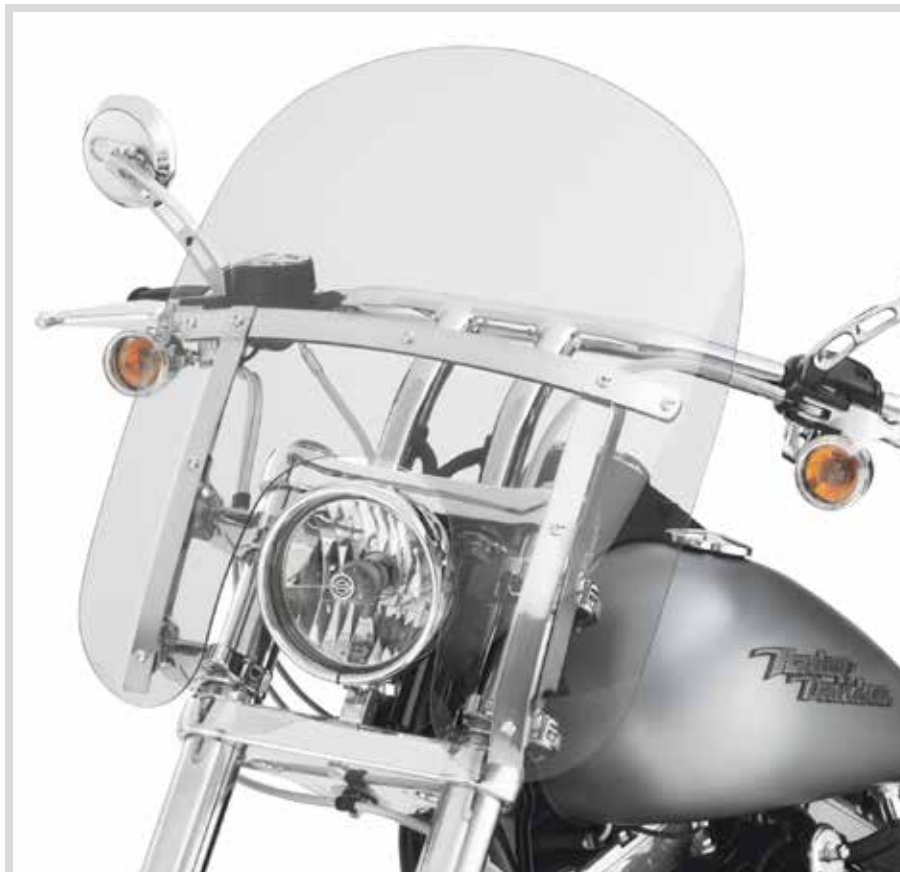
A. ABNEHMBARE KOMPAKT-WINDSCHUTZSCHEIBE – POLIERTE STREBEN
