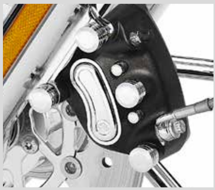
I. CUSTOM-BOLZENABDECKUNGS-KIT FÜR BREMSSATTEL – (40955-05 ABGEBILDET)
