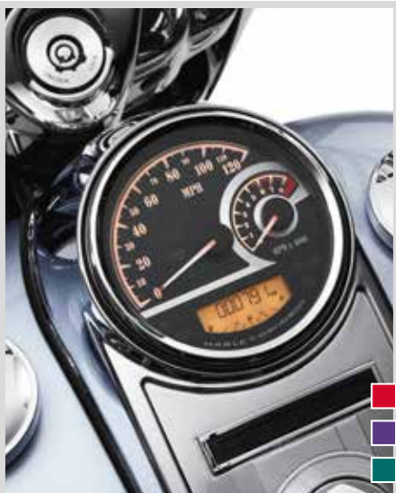
H. KOMBINIERTER ANALOGER TACHOMETER/DREHZAHLMESSER – SCHWARZES 5"-ZIFFERBLATT
