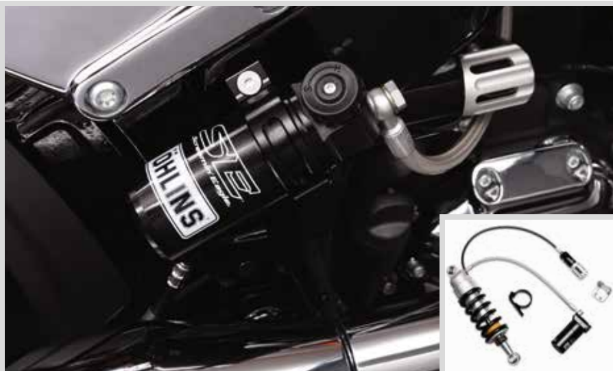
E. SCREAMIN' EAGLE/ÖHLINS HINTERRADAUFHÄNGUNG MIT EXTERNEM AUSGLEICHSBEHÄLTER
