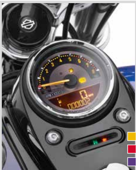
I. DIGITALER TACHOMETER/ANALOGER DREHZAHLMESSER – 4"-ALUMINIUMGUSS-ZIFFERBLATT
